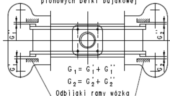
Pomiar luzów na ślizgach pionowych belki bujakowej
